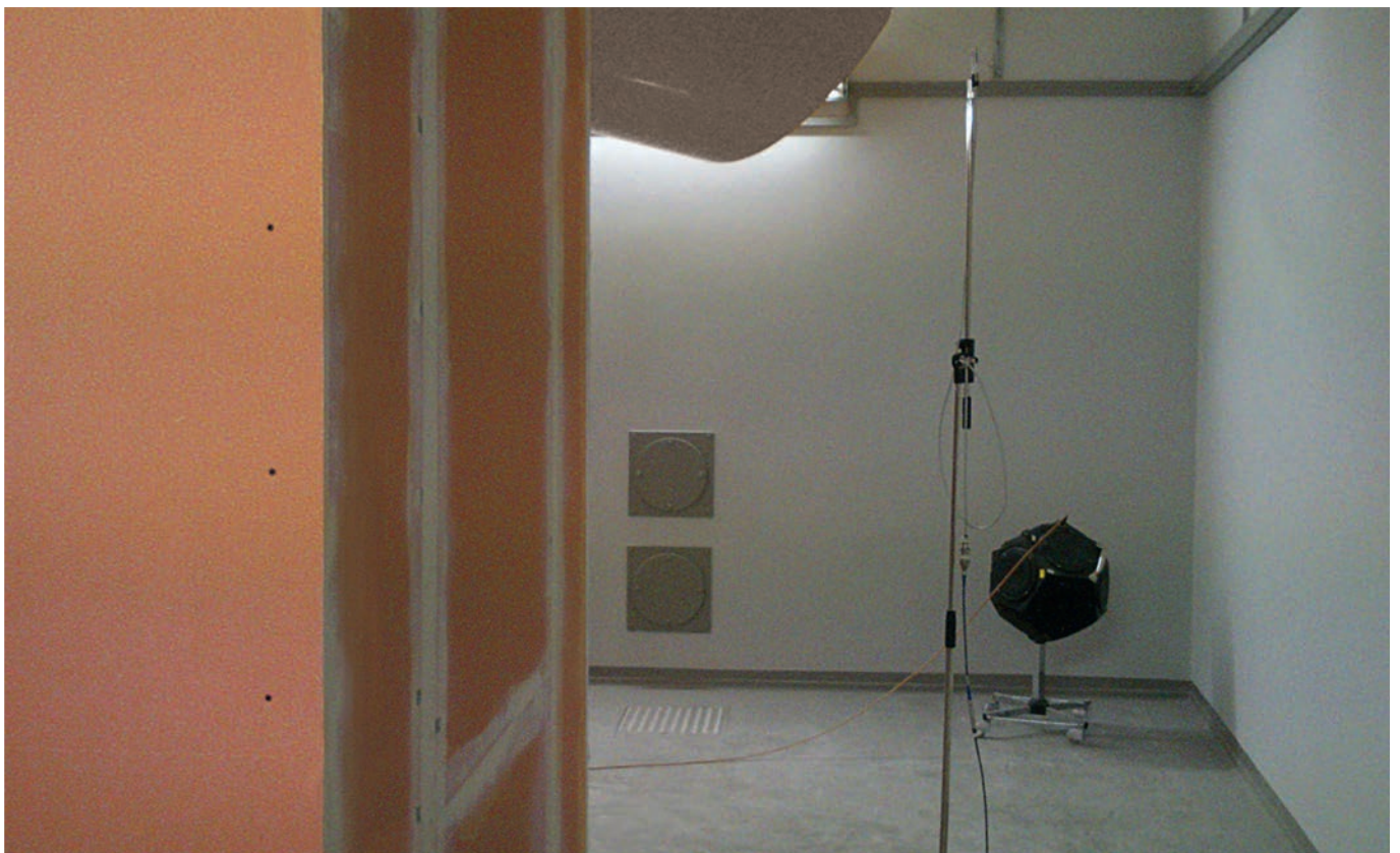
Siniat Raumsystem während der Schallprüfungen im Hallraum
